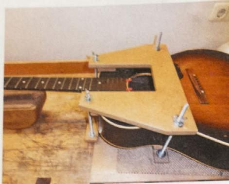
Lösen des Halsfußes aus dem Korpus für den Neck Reset
