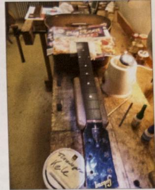
bearbeitet und mit Holzspänen verfüllt oder auch einfach nur verleimt und mit „Cleats“ stabilisiert werden können. Zudem wird die Beileistung geprüft, lose Bracings werden geleimt, mitunter müssen neue Leistchen gefertigt werden.
